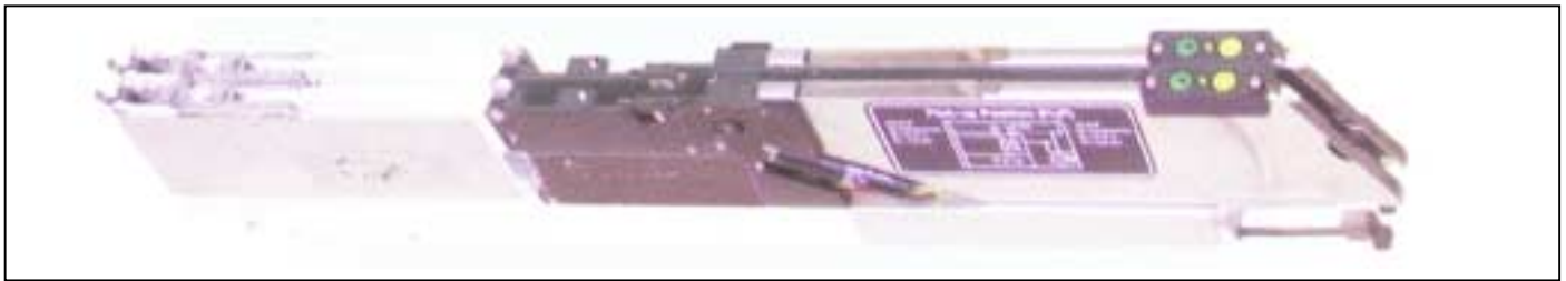
Siemens 2x8 Schulz Feeder 00141096
